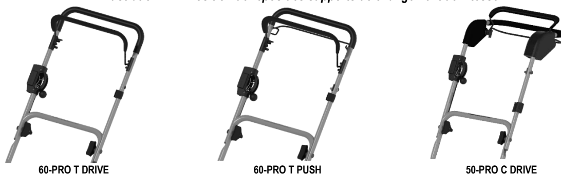
Illustration 4-4 : Position de repos des supports de changement de vitesse
