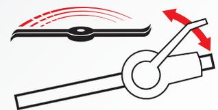
A bordo del SABO 54-K VARIO B: dopo aver rilasciato l'impugnatura di sicurezza, la lama si arresta automaticamente. Il motore continua a funzionare e si può facilmente guidare il tosaerba per svuotare il sacco di raccolta.
