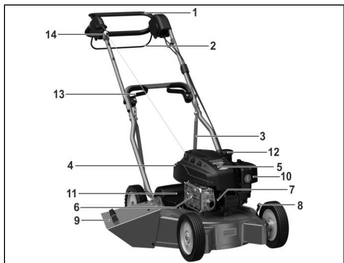
1 Staffa di comando di sicurezza per l'arresto del motore
